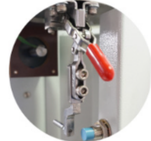
Mecanismo para materiales muy fluidos
